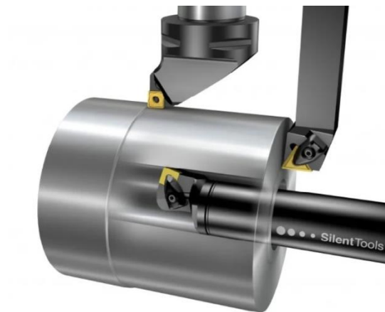
Рисунок 2.2 – Токарне оброблення циліндричних поверхонь
