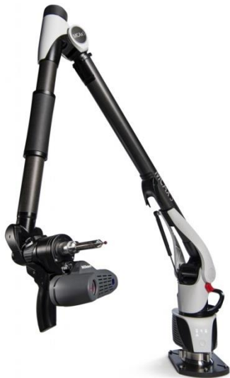
Рисунок 3.13 – Безконтактні пристрої сканування: а) – рука з пристроєм безконтактного сканування, б) – вимірювання блоку циліндрів
